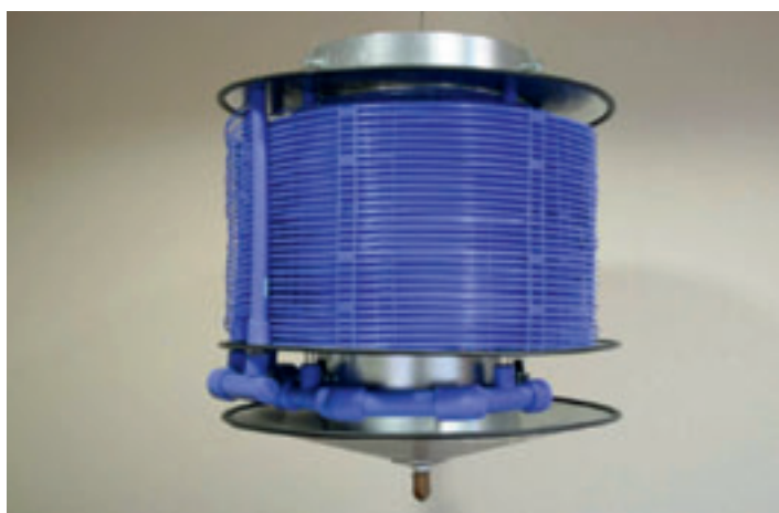
3. Lucht-/brine-warmtewisselaar (afkoeling van een geforceerde luchtstroom door een brine-warmtewisselaar met capillaire buismatten van de firma Clina; apparaatmantel is verwijderd).
