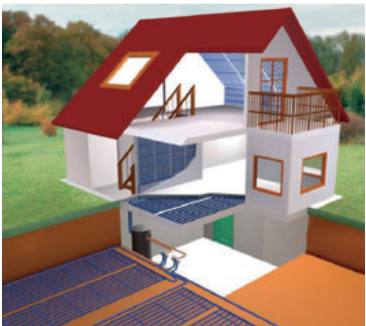
9. Voorbeeld van een uitgebreide toepassing van kunststof capillaire buismatten van de firma Clina voor het verwarmen en koelen van een huis met een warmtepomp als opwekker van verwarmd en gekoeld water voor verwarmen en koelen.
