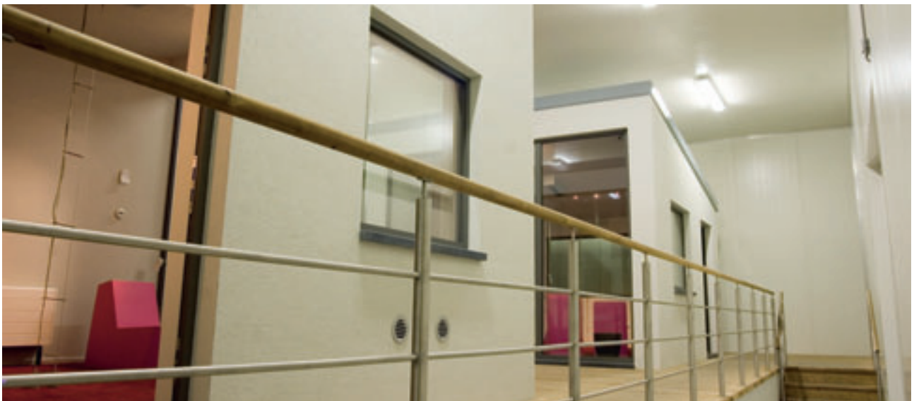
Het experience lab met twee identieke huizen, waarin Jaga de Low-H 2 O-radiatoren in combinatie met een DBE-unit vergeleek met een traditionele paneelradiator.
